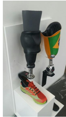
方向転換を要するスポーツ専用の義足
