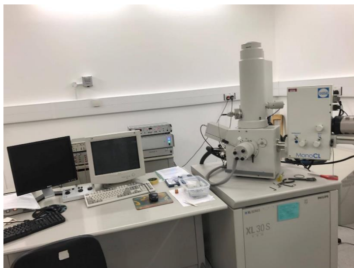
走査型電子顕微鏡(SEM)とカソードルミネッセンス(CL)が組み合わさった装置
