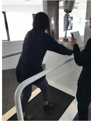
ランニングマシンと義足が連動して動く装置
