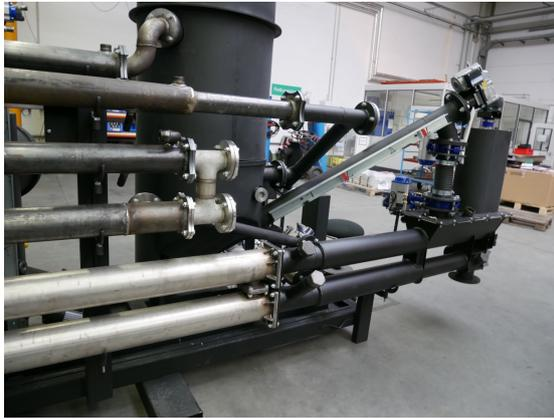
また、上記の写真の背後に写るパイプは生じたガスを通すものであるが、そのパイプはさらに冷却水の通るパイプの中を通過しており、生じた熱を冷却水が奪い、熱交換の役目を果たしている。その後、発電機の方にガスが運ばれ、ここで生じた熱は熱供給システムに運ばれる
