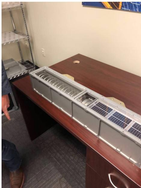
Nanoracksが作る分離機構はとてもシンプルな仕組みで、バネの力で衛星を放出する。ラボでは2種類の分離機構を製作しており、エンジニアの方々からも少しお話をさせていただいた。一つはNRCSDという分離機構で、前述したモデルを組み合わせたものになっている。最大12機同時に放出が可能で、バネを利用した機構であるため低コストである。もう一つはKaberという放出機構で、Kaberは様々な大きさの衛星と互換性があり今までのものよりもやや大きな衛星を放出することが出来る。宇宙ステーションからの衛星放出の需要が高いことが見受けられる。建物を移り、エアロックの製造現場へ向かった。
